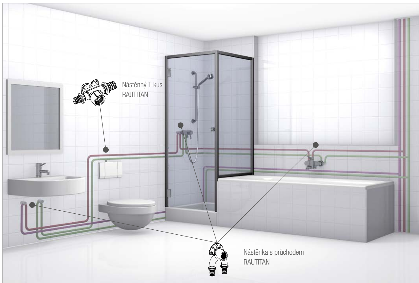
Obr. 5-8 Příklad řadového a okružního potrubí
