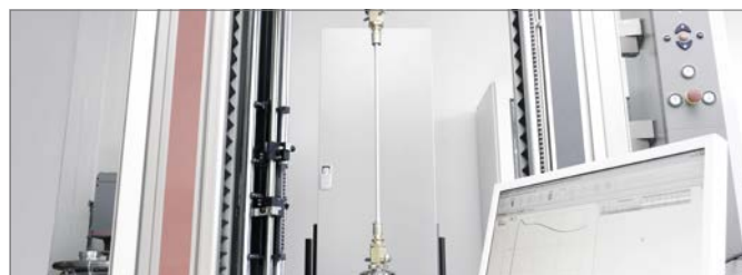
Obr. 3-3 Průběh zkoušky tahem
