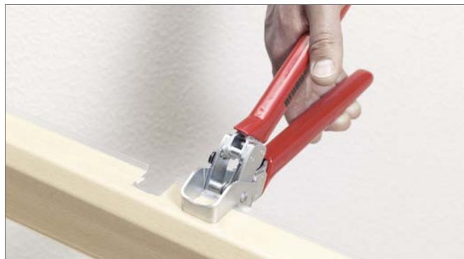
Obr. 16-39 Vyseknutí horního dílu soklové lišty
