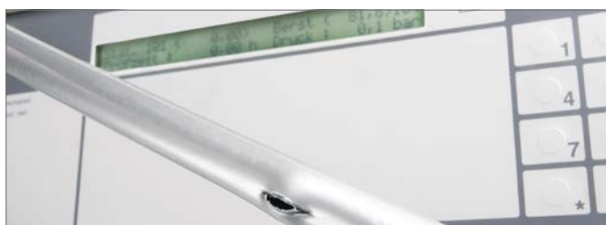
Obr. 3-1 Výsledek zkoušky trhacím tlakem s univerzální trubkou RAUTITAN flex
