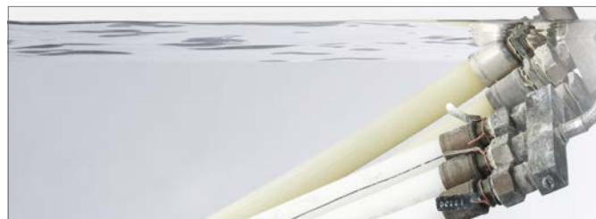
Obr. 3-4 Trubky v dlouhodobé zkoušce (pod tlakem v nádrži s vodou)
