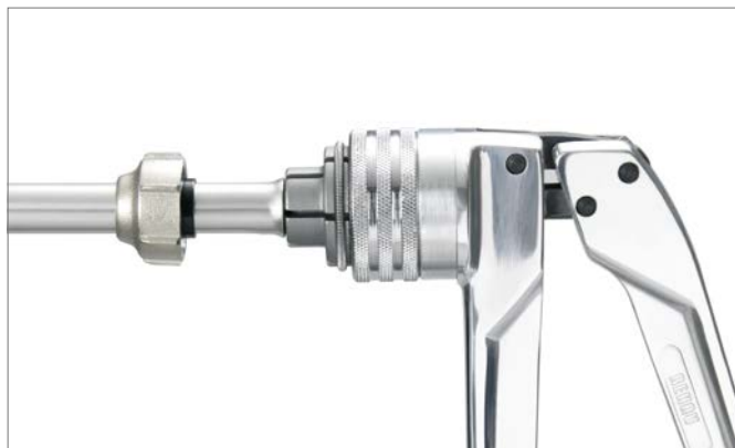
Obr. 13-2 Konec trubky jednou rozšiřte
