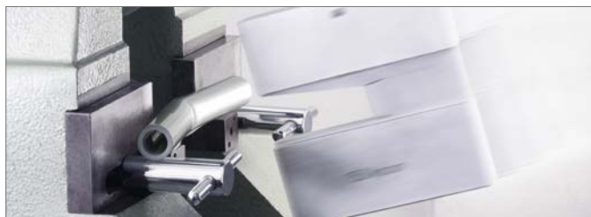
Obr. 3-2 Univerzální trubka RAUTITAN flex v přístroji pro rázovou vrubovou zkoušku
