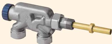
Jednobodové připojení s ponornou trubkou HEIMEIER je určeno pro otopná tělesa, umožňující jednobodové boční připojení (např. některá článková tělesa, apod.). Skládá se z rozdělovače jednotrubkového připojení, vyrobeného z poniklovaného korozivzdorného bronzu, z ponorné trubky (krátké nebo dlouhé provedení) a přehradního kroužku.
