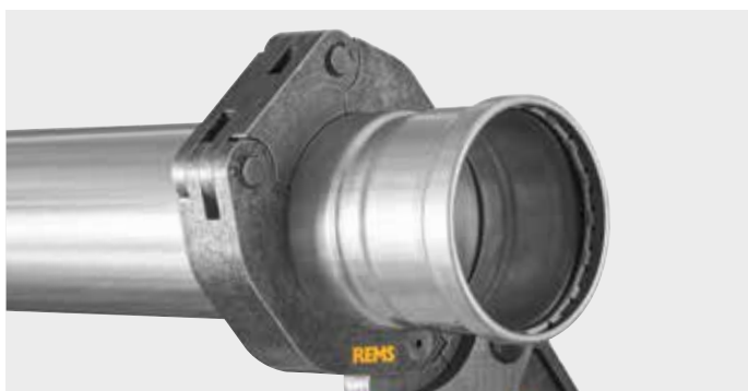
REMS lisovací kroužek (PR-3B) s 3-mi lisovacími čelistmi pro náročná lisování velkých rozměrů. Optimální lisování díky radiálně řízenému pohybu lisovacích čelistí, s mezikleštěmi.
