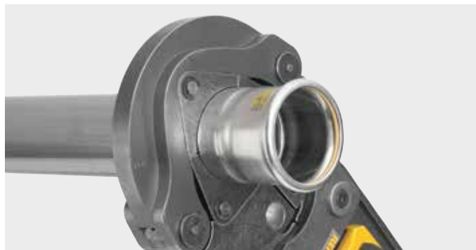
Lisovací kroužek (PR-3S) REMS s 3-mi na kloubovém kroužku vedenými výklopnými lisovacími segmenty pro lisování velkých dimenzí s vysokými požadavky. Optimální lisování díky radiálně řízenému pohybu lisovacích segmentů, s mezikleštěmi.
