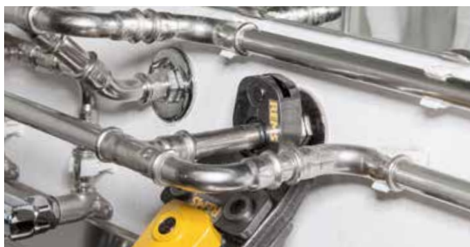
REMS lisovací kroužek 45° (PR-2B) se 2 lisovacími čelistmi k lisování na obtížně přístupných místech, s mezikleštěmi.
