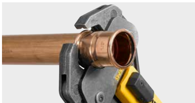
REMS lisovací kleště (4G) se 2 kloubově výklopnými, paralelně vedenými lisovacími segmenty pro přímočaré lisování středně velkých dimenzí.
